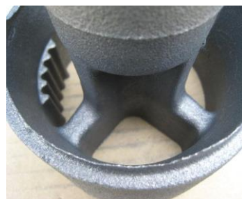
テスト用鑄型を用いて鑄造した鑄鉄鑄物（FC250）
