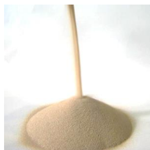
改質リグニン20%変性ノボラック型フェノール樹脂を2.0%被覆したRCSと造型したテスト用鑄型
