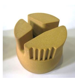
改質リグニン20%変性ノボラック型フェノール樹脂を2.0%被覆したRCSと造型したテスト用鑄型
