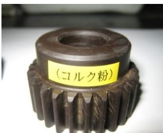
改質リグニン20%変性ノボラック型フェノール樹脂／フィラー=40/60としたコンパウンドと圧力成形品
